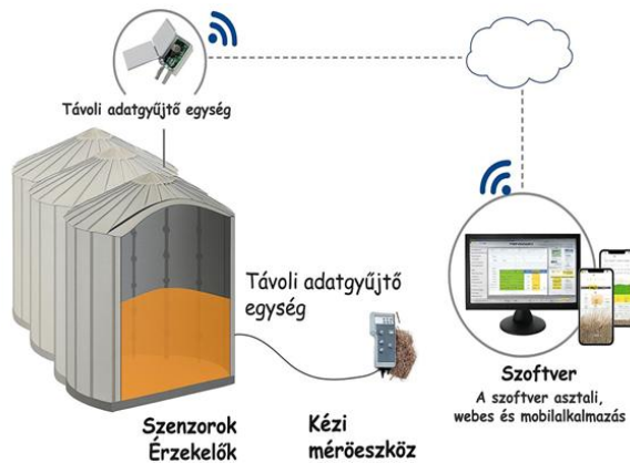
9. ábra. Javasolt intelligens monitoringrendszer a tárolt szemesztermény hőmérséklet-, nedvességtartalom- és CO 2 -viszonyainak felügyeletére (Forrás: saját szerkesztés az Internet1 alapján)
