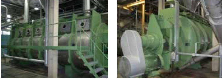
Figure II.10.18: Disc drier (Photo: László Simon, István Szöllősi)
